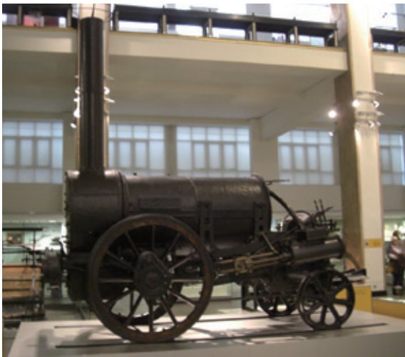
写真⑥ ロンドンの科学博物館に展示されているロケット号。この写真のシリンダーの角度は小さく、ほぼ水平に近いので、開業後に製造された蒸気機関車である。レインヒル・トライアルズで走行したロケット号(写真⑦)はシリンダーの角度がかなり大きいことが判る。
